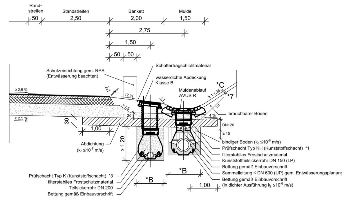
**Einschnitt, Fahrbahnquerneigung nach innen, mit Tiefenentwässerung**
