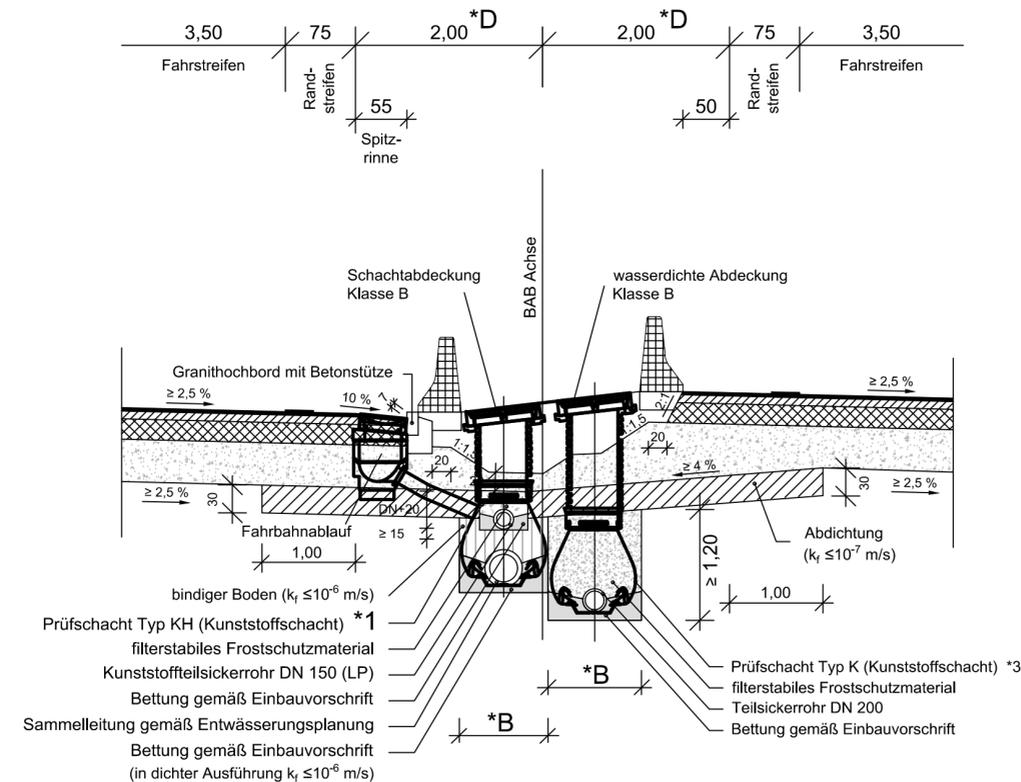
**Einschnitt, Fahrbahnquerneigung nach außen, mit Tiefenentwässerung**
